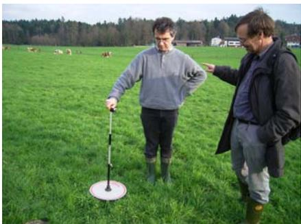
***Messung der Aufwuchshöhe mit Messscheibe***
